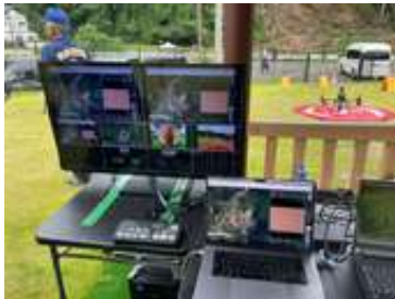
モニターを使用して複数の配信映像を切り替えて確認・配信。ドローンの映像＋飛行地点を衛星インターネット回線を使用して転送。能登半島地震の際には、大手キャリアが不通となり、情報伝達が既存の方法では上手く行えなかったことから、Starlink通信を利用(DBA資料より)
